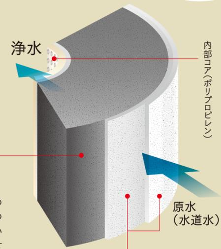
もみ殻を炭素加工したものが、M3カーボンです。この粉末を拡大すると、もみ殻特有の細長い形状と凹凸の多い表層が観察できます。理想的なアスペクト比(長辺と短辺の比率)形状と表面の凹凸が流水をスムーズに分散化。目詰まりが起きにくい、長い期間、豊富な浄水量を供給できるのです。M3カーボンと繊維状活性炭を組み合わせた最新型カーボンフィルターは、動水圧試験で高い通水性能を示す納得の結果を得ています。
